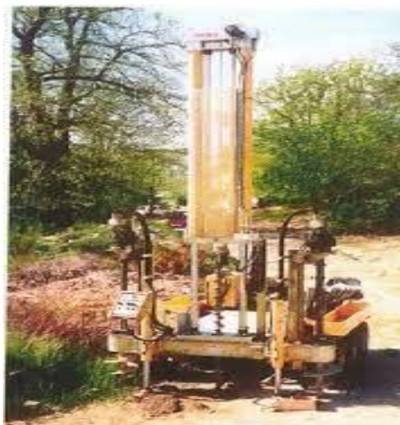
Fotos 7 e 8. Sonda típica para investigações geotécnicas Vane Test a esquerda; a direita palheta, 2023.
