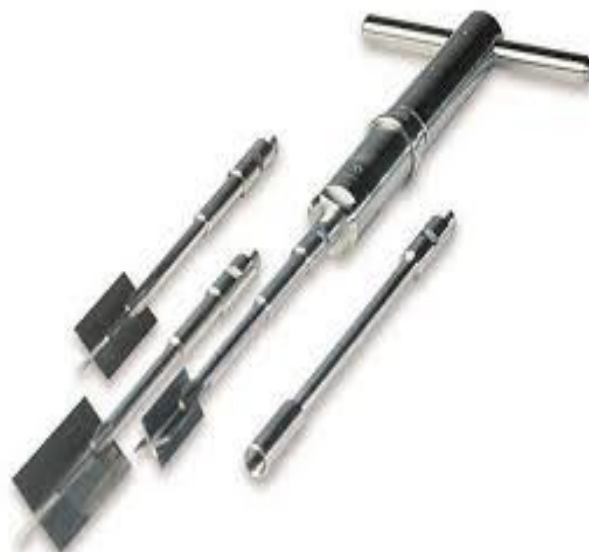
Fotos 7 e 8. Sonda típica para investigações geotécnicas Vane Test a esquerda; a direita palheta, 2023.
