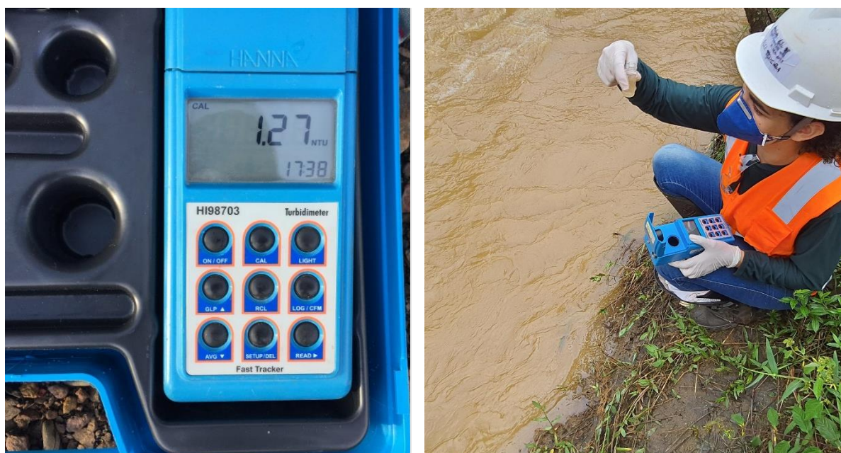
Figura 52 - Turbidímetro sendo utilizado no ponto do córrego Batatal.
