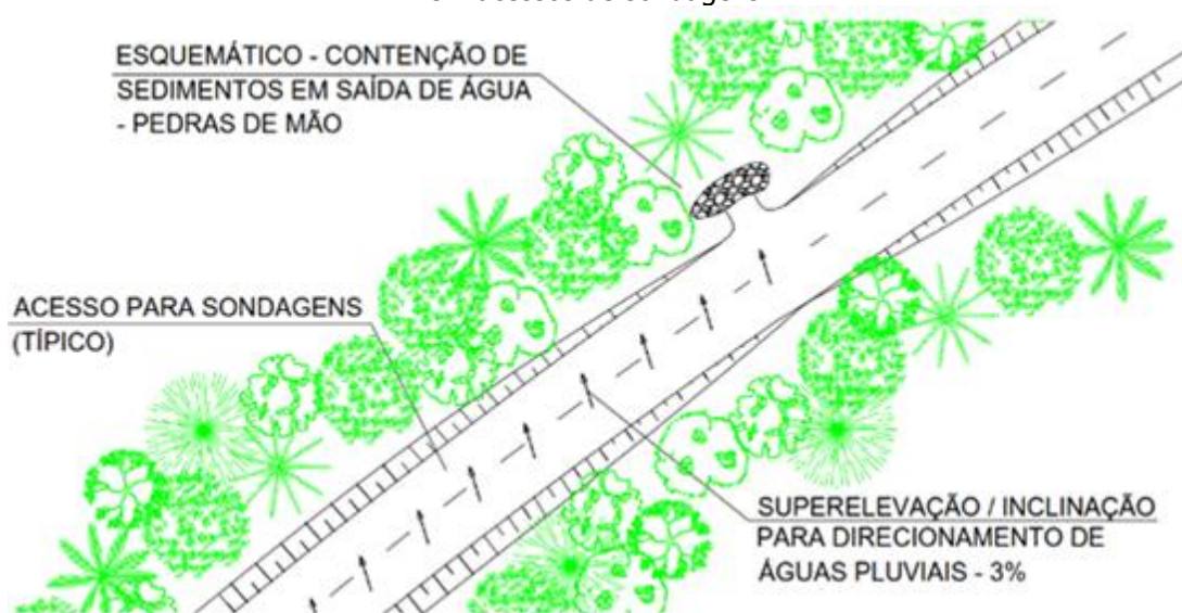
Figura 15. Contenção de sedimentos com pedras de mão em bacias laterais a acessos
