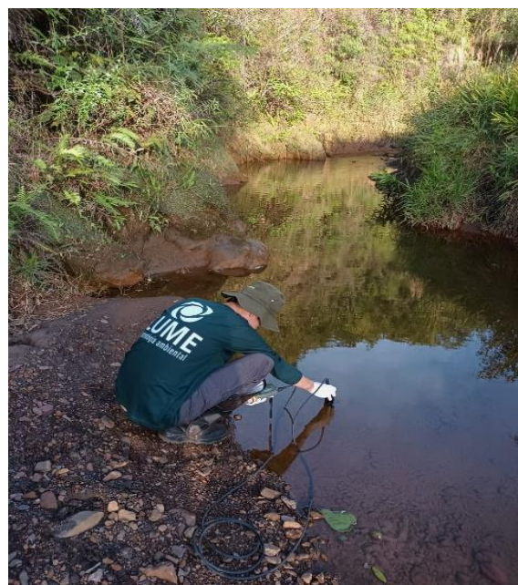
Figura 51 - Sonda multiparâmetro sendo utilizada no ponto do córrego Congonhas montante.
