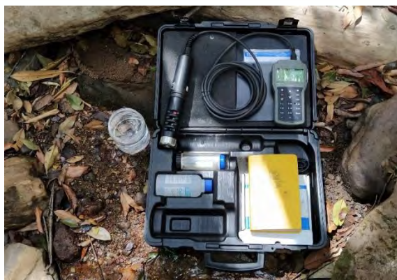
Foto 1-8-149: Sonda Multiparâmetros usada em campo para análise da Qualidade da Água.
