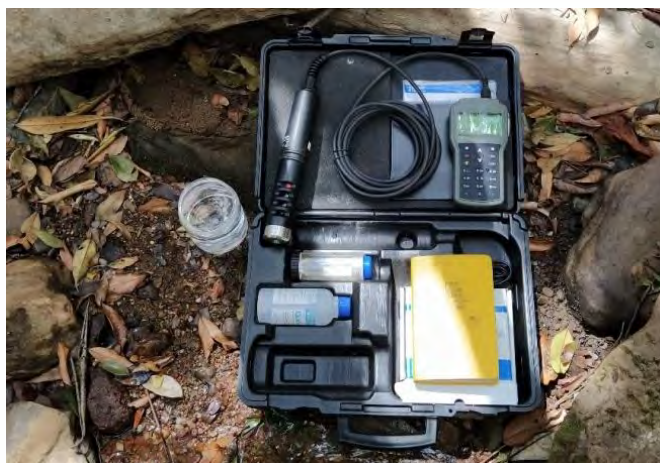
Foto 1-142: Sonda Multiparâmetros usada em campo para análise da Qualidade da Água.
