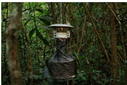
Foto 8-134: Armadilha luminosa CDC instalada na Área A5. A bolsa de coleta está envolvida por um saco plástico para proteção contra chuva.
