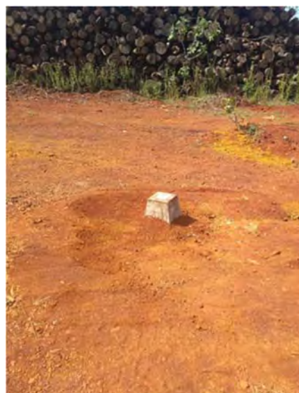
Foto 6-6: Furo de sondagem tamponado, Vale 2021
