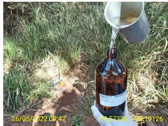
Figura 6-91 - Transferência para o frasco de acondicionamento
