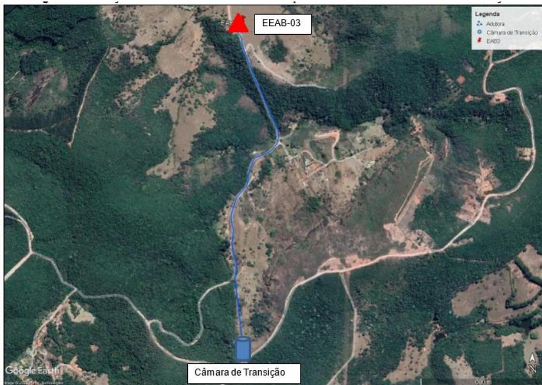
Figura 4-25 - Traçado da Adutora Trecho I | Tramo EAB3 / Camara de Transição. Fonte: Arcadis (2022)
