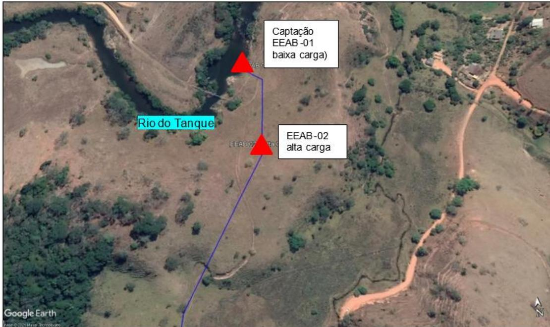
Figura 4-16 - Ponto de Captação e Localização da EAB1 e da EAB2. Fonte: Arcadis (20220)
