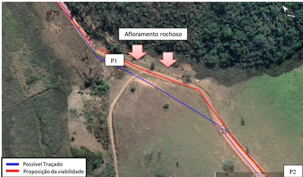
**Figura 3-21 - Adequação no Traçado da Adutora - Trechos em Estradas. Fonte: Arcadis (2021)**
