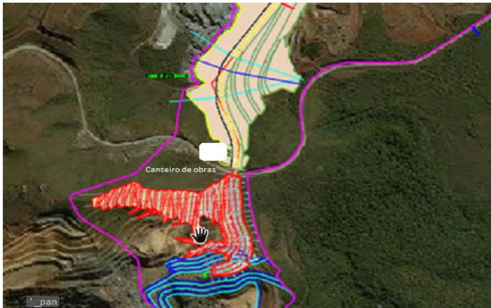
Figura 2 – Vista aérea das áreas de intervenção (encontros norte e sul do viaduto), mostrando a área de aterro a norte, de corte a sul e a localização do canteiro de obras, junto à rodovia MG 442.
