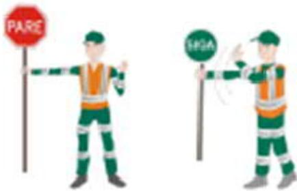
Figura 94 Exemplo de Sistema Pare e Siga em via com obras.
