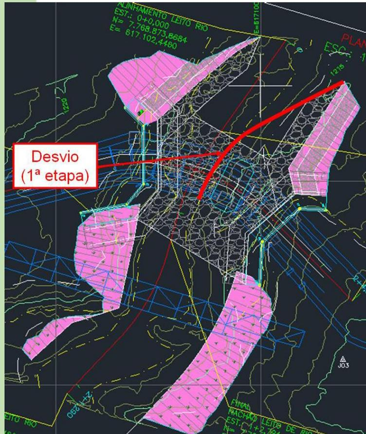
Figura 11 – Indicação da primeira etapa de desvio do curso d'água para realização das obras junto à margem esquerda e bases 43/53.
