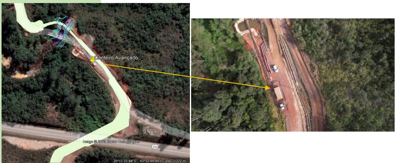
Figura 8 – Estrutura temporária de canteiro de obras – frente avançada – para atendimento às intervenções emergenciais.
