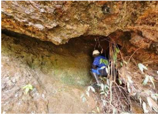
Foto 65 - Galeria 27, entrada da galeria no contato entre a bacia sedimentar e a exolaterita.
