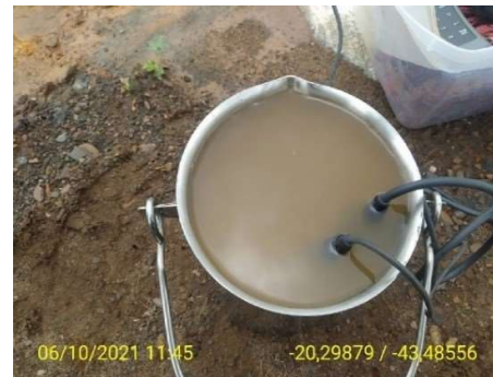
Foto 63 Registro dos procedimentos de coleta no ponto de amostragem na saída do vertedouro
