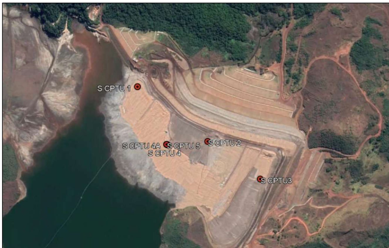
Figura 7.7– Localização dos ensaios CPTU sísmicos.
