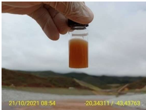
Foto 66 Registro dos procedimentos de coleta no ponto de amostragem na saída do vertedouro
