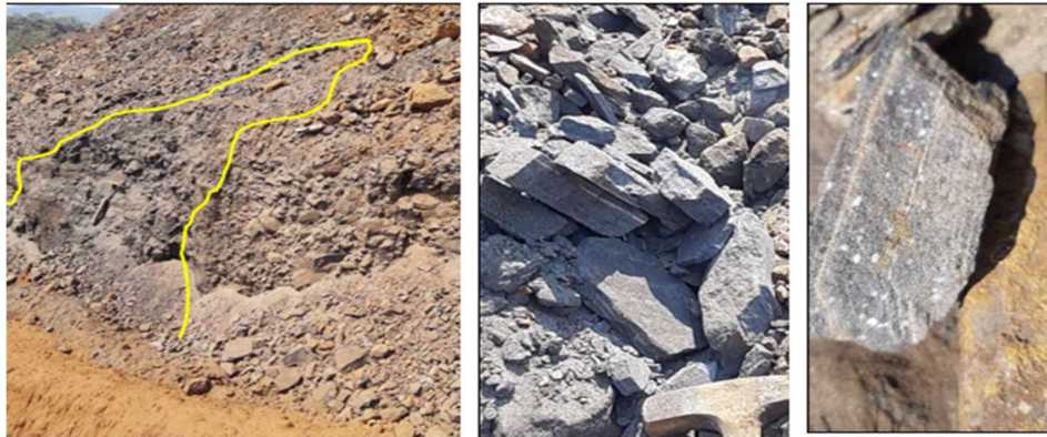
Foto 41 Afloramento segundo a estrada, com lente de hematita de quase 2m (detalhe em amarelo) de espessura em meio ao saprólito de quartzo mica xisto
