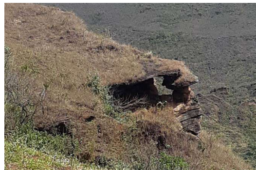
Foto 35 Camada de Itabirito cobrindo o grande afloramento de dolomito. É possível observar uma feição cárstica. Rocha, com níveis argilosos e silicosos com alteração W5. Autor: Walm, 2020
