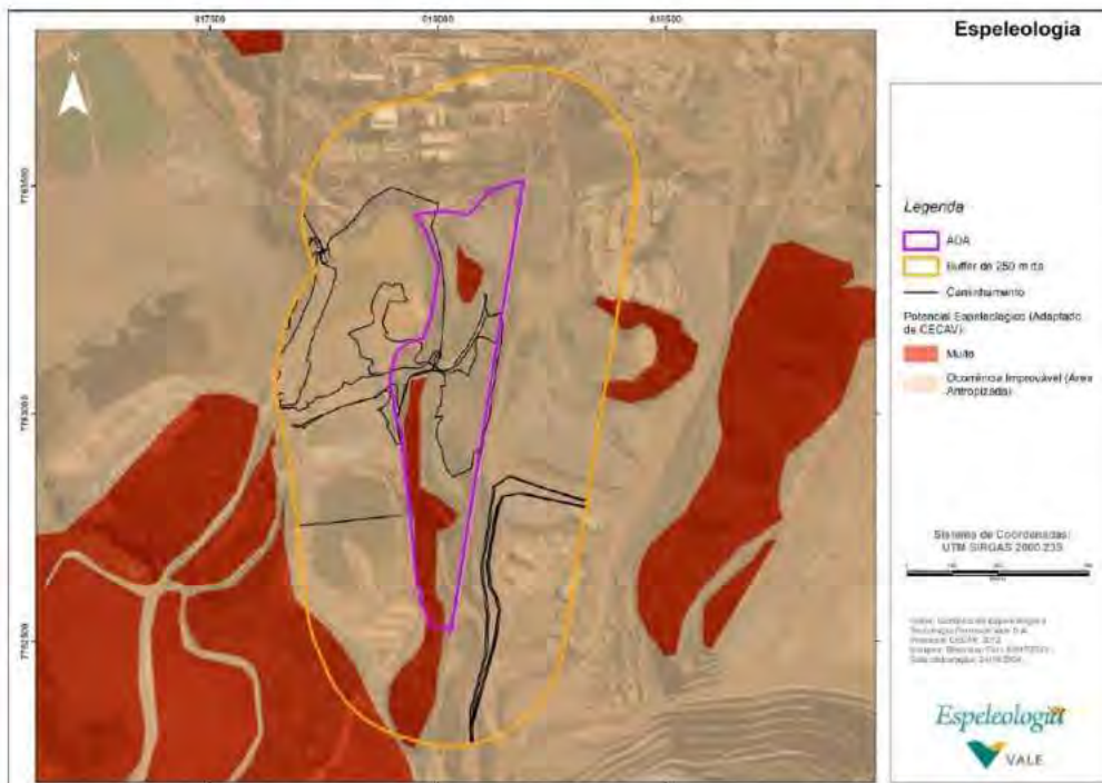
Figura 1: Mapa de potencial espeleológico do CECAV (segundo Jansen, 2011) com os caminhamentos das prospeções realizadas na ADA e no entorno dos 250m da obra emergencial Maravilhas da mina do Pico (Anexo I).
