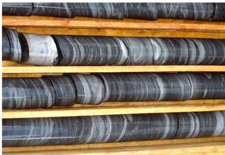
Figura 05 Foto ilustrativa de testemunho de sondagem
