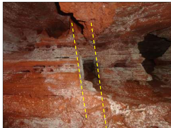
Foto 6.33 - Fraturas subverticais observadas em uma das paredes da cavidade. Nota-se a angulosidade do canalículo, ocasionada seção das fraturas no bandamento do itabirito.
