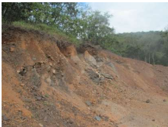
Foto 22 Movimentos de massa (tombamento e deslizamento) em afloramento de itabirito friável na porção central da área do projeto (ponto P2 - coordenadas UTM 687956/7.794.096).
