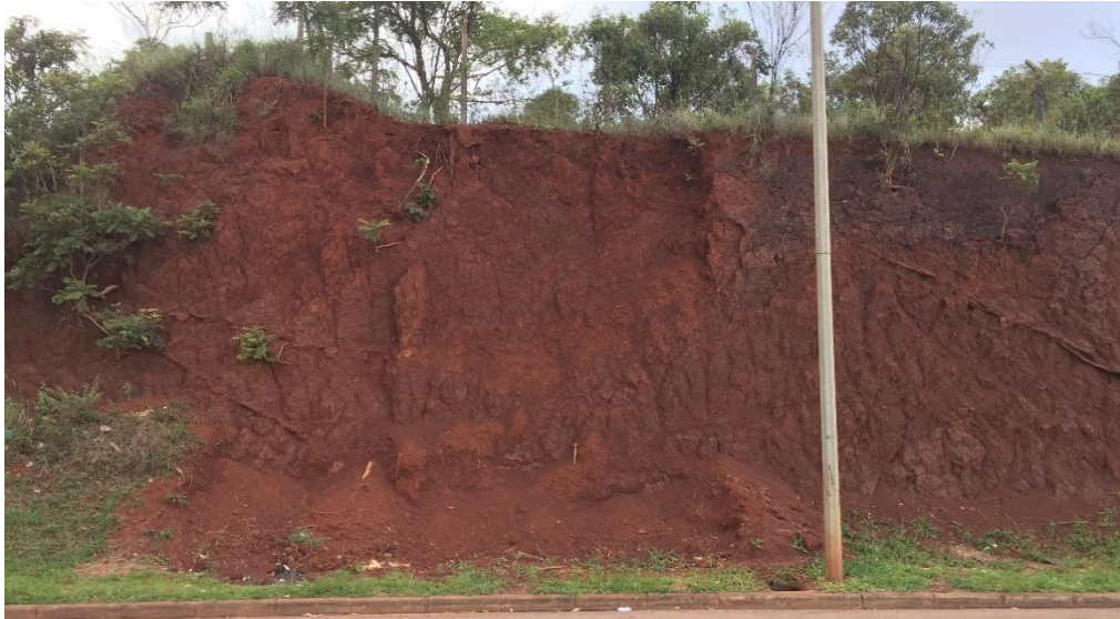
Figura 20 – Latossolo desenvolvido sobre sedimentos argilosos, localizado às margens da BR-040, próximo ao conjunto de sondagens de Mar Azul. São comuns as crostas placoidais preenchendo os sistemas de falhas e fraturas. Coordenadas UTM: 606.761,77 E; 7.781.047,29 N.
