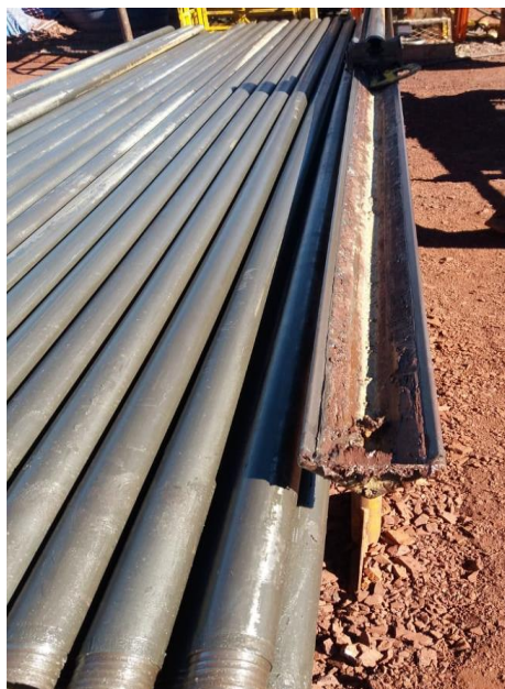
Figura 6 - Foto ilustrativa de conjunto de hastes de perfuração. Fonte: VALE, 2021.
