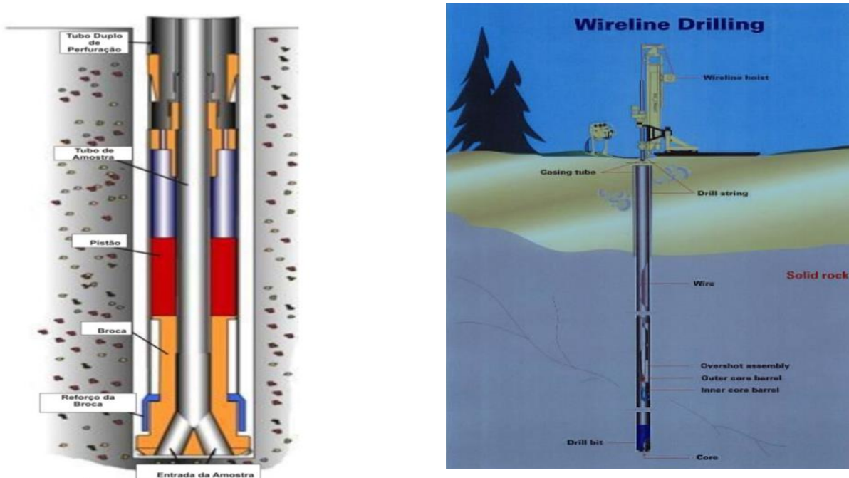
Figura 5 - Sondagem rotativa testemunhada Wire Line . Fonte: VALE, 2021.
