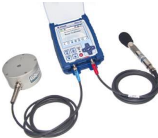
Figura 5-23 - Simógrafo Instantel Micromate com microfone e geofone Fonte: ECOAR, 2020
