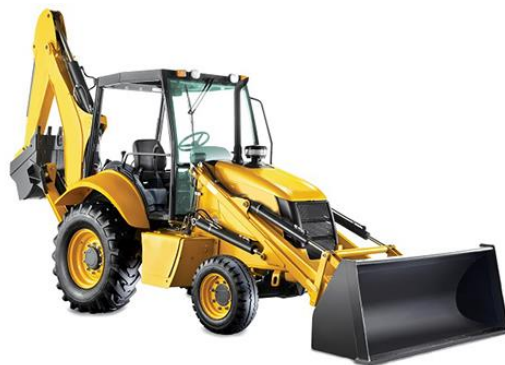
Figura 4-19 - Retroescavadeira New Holland usada na implantação
