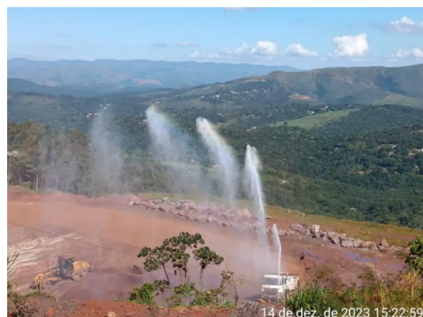
Foto 16. Aspersão de água por canhão aspersor e umectação do deslocamento dos caminhões não tripulados. (Fonte: Vale, dezembro de 2023).
