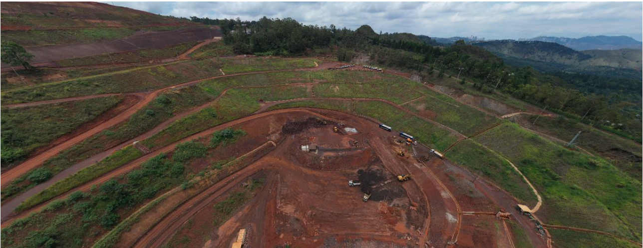
Foto 12. Vista da PDE-X após processo de revegetação bem estabelecido das ombreiras da barragem. (Fonte: Vale, 29 de janeiro de 2024).
