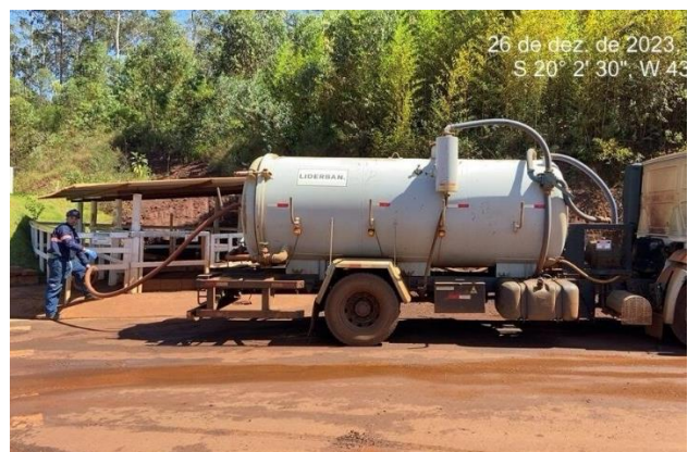
Foto 18. Higienização do tanque estanque. (Fonte: Vale, 2023).
