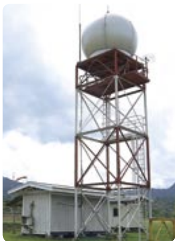
Peralatan Radar digunakan untuk menentukan saat yang tepat untuk proses penyemaian awan. Radar equipment is used to time the cloud seeding process.
