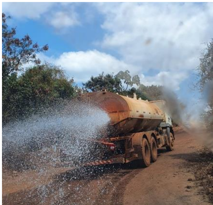
Figura 13: Umectação de vias por caminhão pipa. (Fonte: Vale, 2022.)
