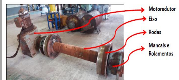
Figura 2: Detalhamento do conjunto de truck motriz
