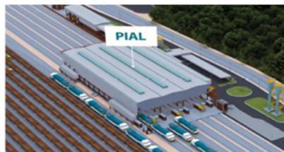
Enquanto ocorre a descarga automática dos vagões, as locomotivas seguem para pitstop no Posto de Inspeção e Abastecimento de Locomotivas (PIAL), com capacidade para atender até 12 locomotivas.
