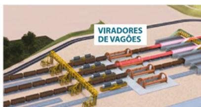
Os trens de minério que vêm de Carajás (PA) com 330 vagões são separados em blocos de 110 vagões para descarga em 8 viradores de vagões. O processo de descarga é totalmente automatizado.
