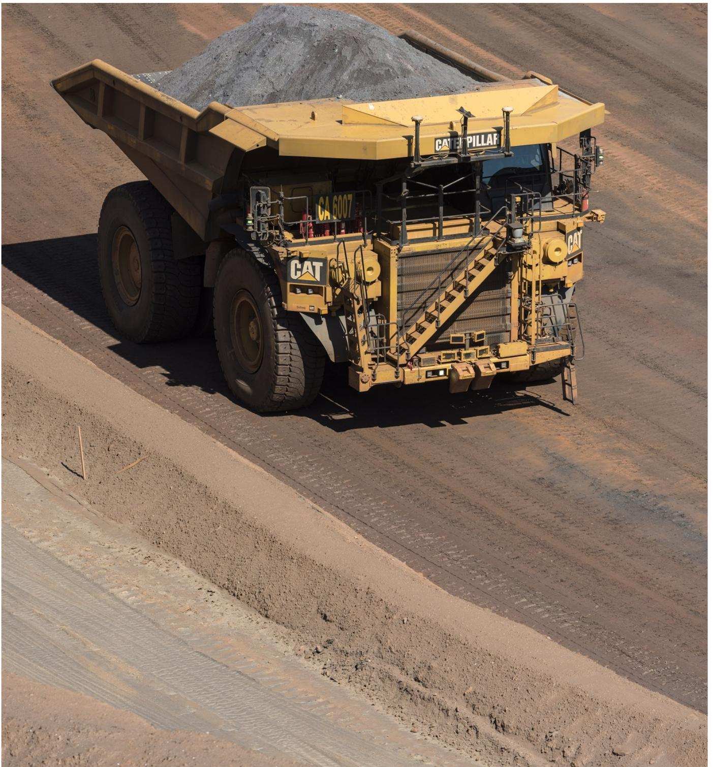
Você sabia que na Mina de Brucutu, em MG, caminhões fora de estrada, com capacidade para transportar 240 toneladas, são operados por computadores através de sensores inteligentes e sistemas de navegabilidade de alta precisão?
